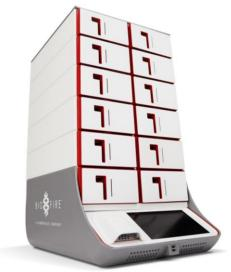
Grâce au contrôle intuitif du système, à son lecteur de codes-barres intégré, à son interface tactile et à la technologie FilmArray<sup>®</sup> Link, FilmArray<sup>®</sup> Torch permet d'optimiser l'expérience utilisateur et s'intègre parfaitement au système informatique du laboratoire.
